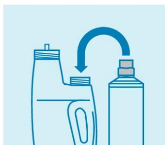
3. Zum Nachfüllen der Dosierflasche die Nachfüllflasche auf den Dorn (rote Kappe) der Dosiereinheit setzen und herunterdrücken, um die Versiegelung zu durchbrechen. Warten, bis die Flasche entleert ist.
