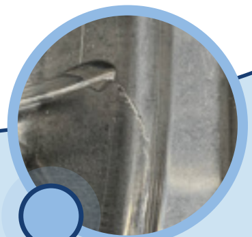
Geschädigte Oberfläche führt durch Kontakt mit Speisen zu VERFÄRBUNGEN
